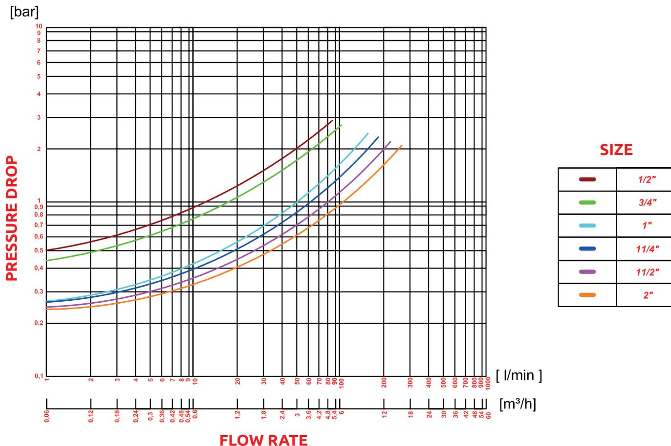
Il diagramma delle perdite di carico del riduttore, rappresenta la perdita di pressione in funzione della portata all'uscita delle utenze.
